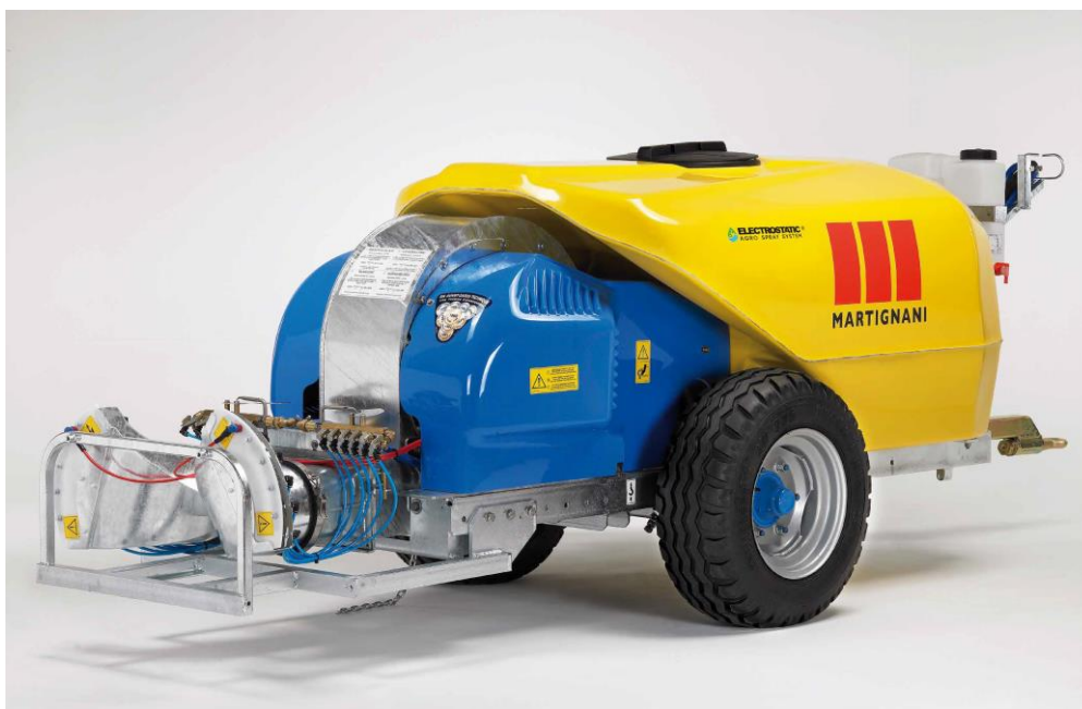
WHIRLWIND M-612 1000 l permetezőgép elektrosztatikus 70°x4 cm diffuzor csoporttal
