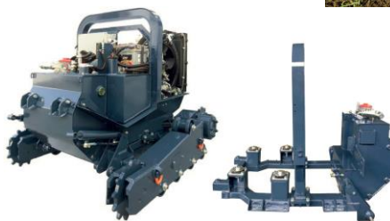
Vázzal egybeépített biztonsági bukókeret
