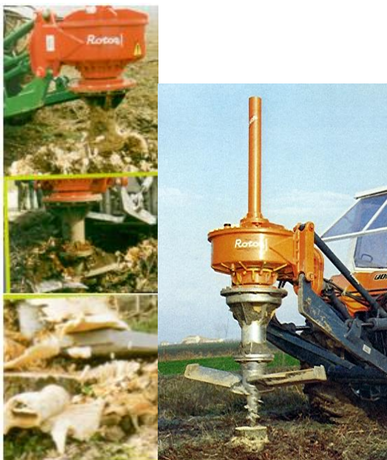
ROTOR S Ø 1200 mm vrták s bočným nožom
