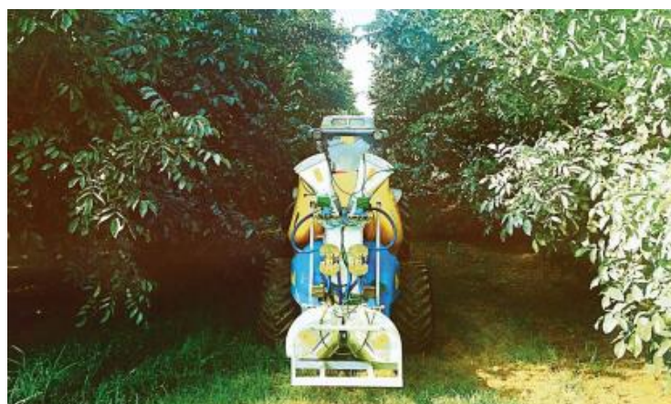
M-612 WHIRLWIND 2 kiömlőnyílású MAJOR ventilátorral, vontatott kivitelű elektrosztatikus speciális Dió diffúzor párral
