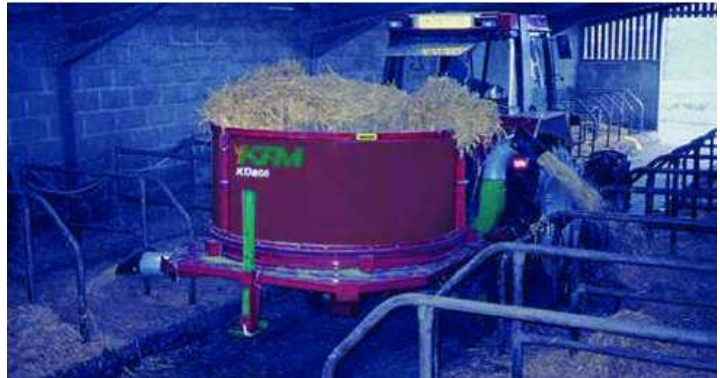
Ürítés elől jobb oldalon (90°) (12220113+12220115) és hátul bal oldalon (45°) (12220114) galvanizált csövön keresztül, mely történhet egyszerre is.
