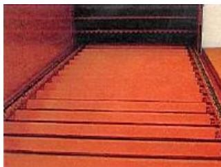
A nagyméretű etetőgarat behordó láncsal és behúzó hengerrel
