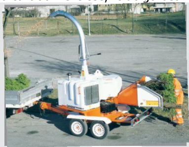
C09 MTS vontatott nyese dékaprító, sajátmotoros
