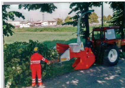
C13 TPS függesztett nyese dékaprító
