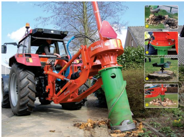
ROTOR SPEEDY 80/100 hidraulikus kitolóval szerelt fúróhengerrel
