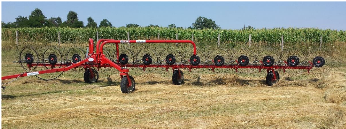
FAZA RTR/13-4R vontatott csillagkerékű rendszáró (cikkszám: 03000071040)
