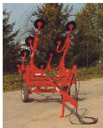
CTH/8 vontatott csillagkerekű rendsodró tárolási / szállítási helyzetben
